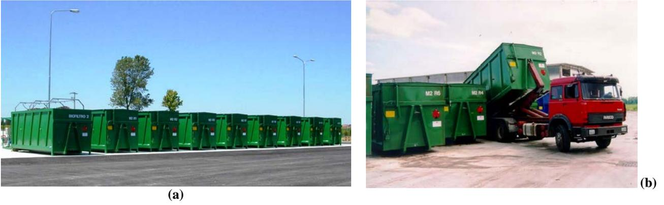
**Fig. 4. Container system: a) view of the modular system, b) truck operation.**(Le Coccinelle ® Entsorga - <http://www.entsorga.it>)
